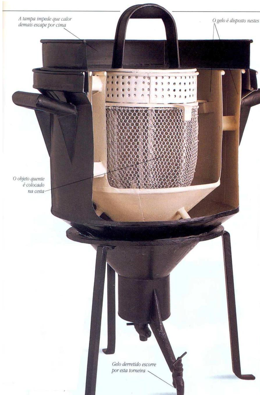
Visão em corte de um *calorímetro de gelo* dos cientistas **Lavoisier** (1743-1794) e **Laplace** (1749-1827). Com este aparelho mede-se a quantidade de calor liberado por um objeto quente à medida que ele esfria. O objeto esfria até o ponto em que para de derreter o gelo, adquirindo a mesma temperatura deste. A água derretida é escoada pelo fundo do calorímetro. O peso dela determina a capacidade térmica do objeto.
