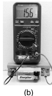
Figura 1.19 - (a) Circuito com uma pilha; (b) Foto da montagem do circuito, onde o Voltímetro indica V_0 = 1,56V
