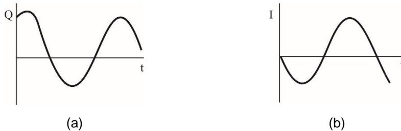
Figura 6.3 - Comportamento típico de Q(t) e I(t) em um circuito LC
