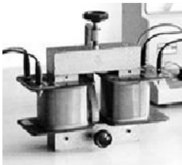
Figura 5.15 - Bobinas com núcleo de ferro fechado
