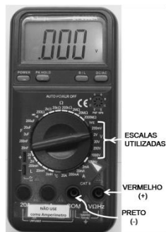
Figura 1.18 – Ilustração do Voltímetro (Politem POL-45)
