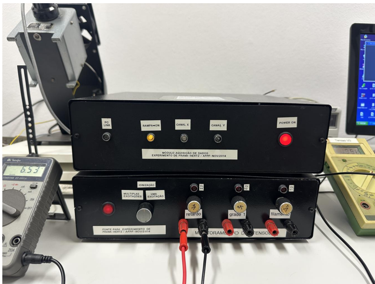
Figura 4 – detalhe da interface de controle com os botões de liga/desliga e potenciômetros de ajuste e multímetro para ajuste das tensões (V1, V2 e V4).
