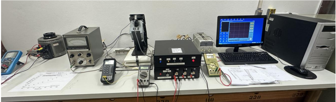
Figura 2 - Visão geral do experimento, da esquerda para direita, multímetro de controle da tensão de saída do Varivolt, Varivolt, eletrômetro, multímetro de leitura de temperatura da válvula, válvula e ventoinha, interface de controle e multímetro para ajuste das tensões ( V_1 , V_2 e V_4 ), fonte de tensão e multímetro para ajuste de V_3 e microcomputador de controle.
