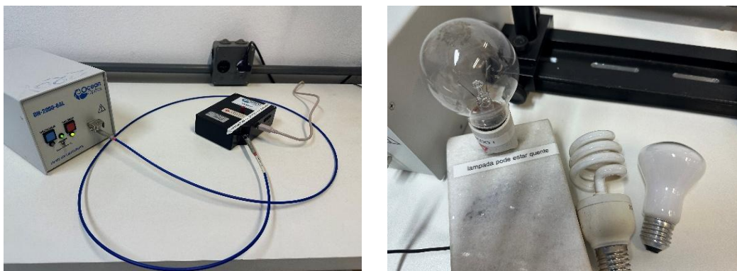
Figura 1 - Ilustração da montagem para medida espectral de algumas lâmpadas.
