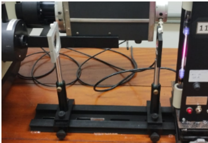
Figura 3: Lentes sistema óptico. Da esquerda, uma lente com foco de 20 cm e da direita, de 5 cm
