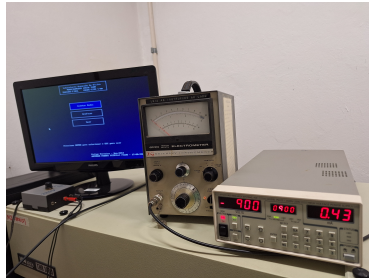
Figura 6: Da esquerda para direita: Software para coletar os dados, eletrômetro e fonte de alimentação. Elaborado pelos compiladores
