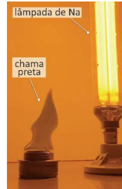
(II) Chama na presença de solução de NaCl, irradiada com lâmpada de Na.
