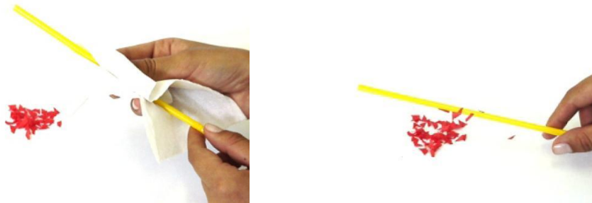
Figura 1.6 - Verificação da eletrização de um canudo de plástico por atrito. (a) (b)
