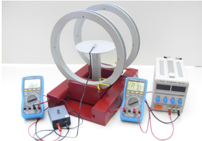
Figura 10.16 - Configuração para mapeamento do campo magnético de uma bobina de Helmholtz.
