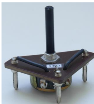
Figura 3.9 - (a) Exemplo de potenciômetro. (b) Símbolo elétrico do potenciômetro.
