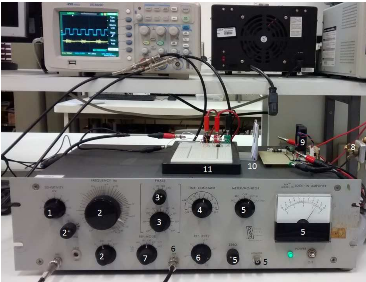
Figura 22.12: Foto da montagem utilizada para medida da transmissão de luz em folhas de papel através de um lock-in comercial.
